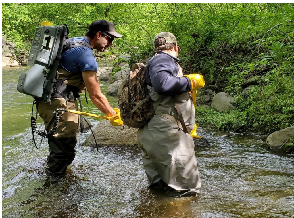
Figure 6 : Utilisation d'un appareil de pêche à l'électricité de type "sac-à-dos" de marque Smith-Root, modèle LR-24. (Source : OBVC)
